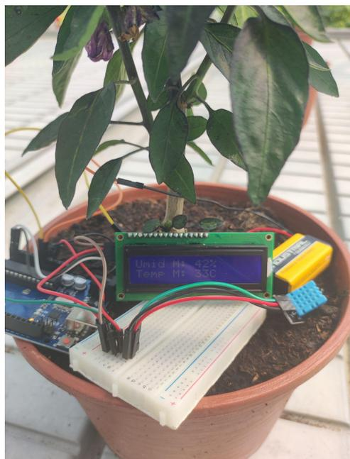
All'interno di ogni area è stato posto il sensore che, collegato ad uno schermo LCD, consentirà inizialmente la raccolta manuale dei dati e successivamente sarà possibile automatizzare anche questo passaggio.
