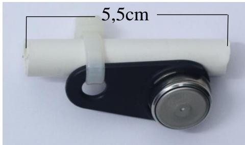
Das Aufsteckrohr wird später auf das mittlere Rohr geschoben und ist herausnehmbar, damit der iButton herausgenommen und ausgelesen werden kann.
