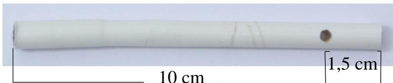
Dieses Rohr ist in der Mitte des Strahlungsschutzes. Auf dieses Rohr wird später das Rohr mit dem iButton geschoben und durch das Loch kommt eine Büroklammer um den Strahlungsschutz zu verschließen.
